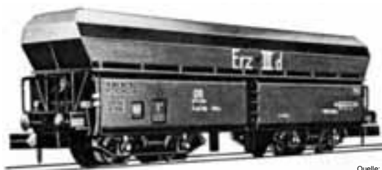
Großraum-Selbstentladewagen, Modell des Fad 157 der DB, rotbraune DB-Lackierung, zum automatischen Be- und Entladen mittels Schüttgut-Umladevorrichtung Nr. 9482, L&P: 72 mm.
