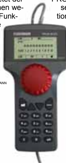
▲ (686601) DCC-Zentrale PROFI-BOSS, Fahren, Schalten & Programmieren, vollgrafisches Display
