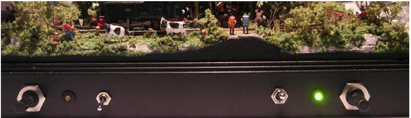
Die Bedienelemente (noch ohne Beschriftung) auf der Vorderseite des Sockels (Anlage betriebsbereit aber ohne Beleuchtung)
